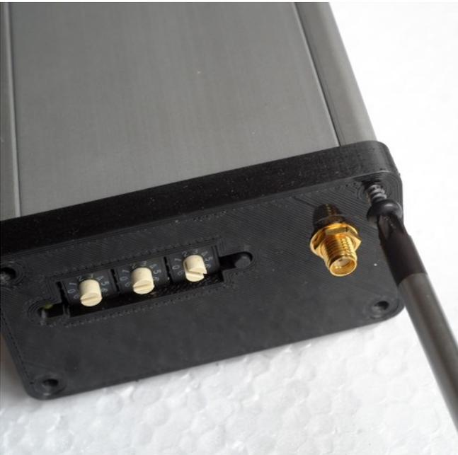
Vissez les deux bouchons avec les 8 vis à têtes bombées du kit. Ne pas utiliser les vis à têtes fraisées d'origine du boîtier.
